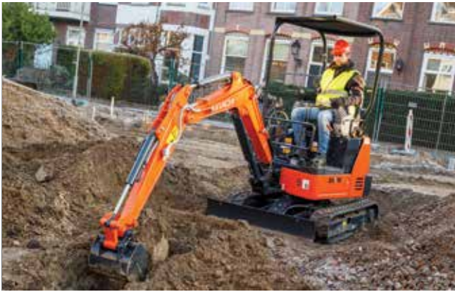
Geniřletilebilir paletler çok yönlü çalıřma imkanını ve stabiliteyi artırır.
