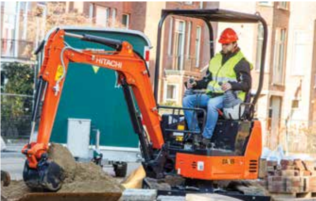
Geniş ayarlanabilir süspansiyonlu koltuk operatör rahatlığı için dizayn edilmiştir.
