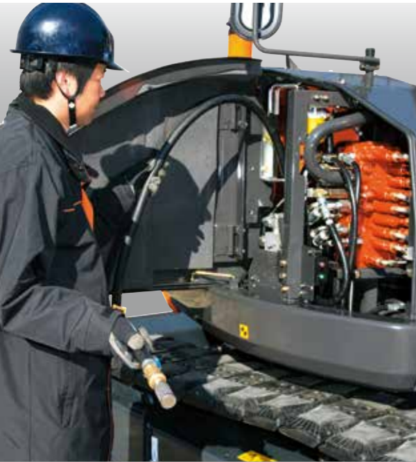
Elektrikli Yakıt Yükleme Pompası
