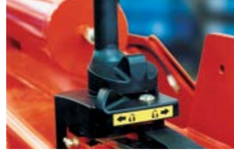
INTERLOCK GÜVENLİ VİNÇ İŞLETİMİ
