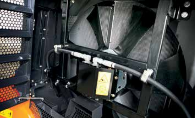
Akıllı fan çalışma sistemi radyatörlerin tıkanmasını önler.
