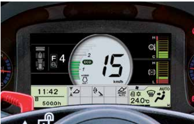
7 inç çok işlevli LCD renkli monitör, tüm ana lastikli yükleyici işlevlerine erişim sağlar.
